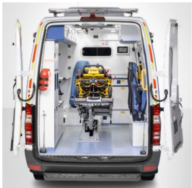
Der WAS elektrohydraulische Tisch sorgt für rückschonendes Beladen des Patienten und einen ruhigen Transport.
