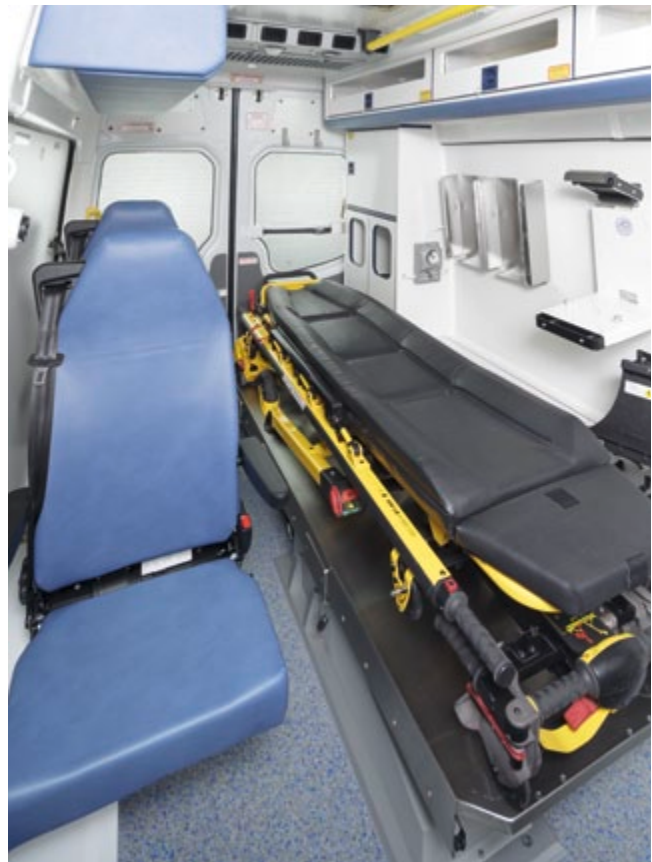
Der WAS elektrohydraulische Tisch sorgt für rückschonendes Beladen des Patienten und einen ruhigen Transport.
