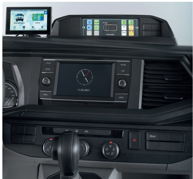
Das zentrale Bedienfeld für die Warnanlage ist in einer Aufbaukonsole am Armaturenbrett untergebracht.
