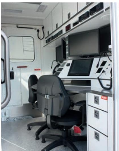
Der Funkraum des Sprinter ELW 1 verfügt über zwei vollwertige, gleichberechtigte Funkarbeitsplätze.
