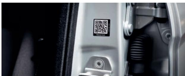
Der QR-Code wird an gut zugängliche Stellen wie die B-Säule geklebt.
