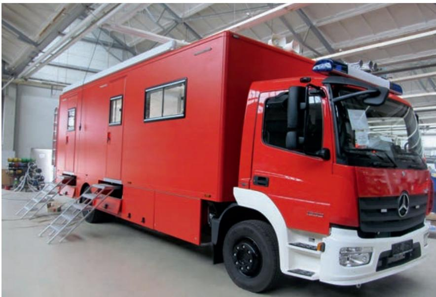
Derzeit noch im Aufbau befindet sich der Einsatzleitwagen ELW 2 vom Aufbauhersteller **Binz Ambulance- und Umwelttechnik**, gebaut auf einem Mercedes-Benz Atego 1530 Fahrgestell nach DIN 14507-3. Ebenso wie der ELW 1 ist der ELW 2 ein
