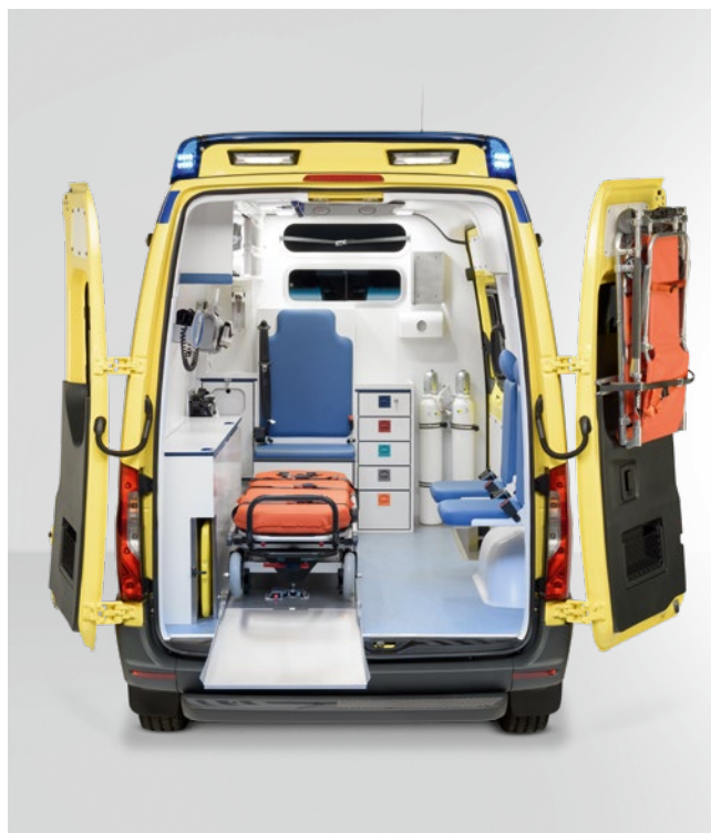
Die Trage wird sicher und stabil über eine Beladerampe in das Fahrzeug gebracht.
