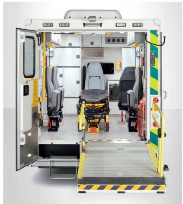
Eine ausfahrbare Hebebühne erleichtert das Be- und Entladen.
