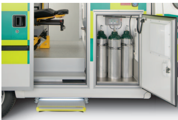
Einfacher Zugang zu Sauerstoffflaschen von der Außenseite.
