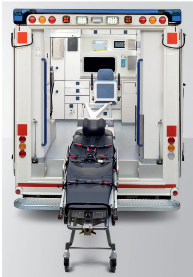
Die rückenschonende Einzugschilfe WAS Multi-Load Assist ist für alle gängigen Fahrtragensysteme konzipiert.
