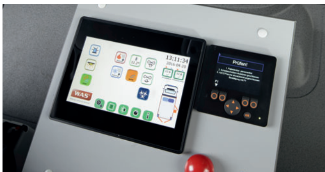
Eine große 7"-Touch-Bedieneinheit sowie die Steuerung für das WAS SanSafe Desinfektionssystem befinden sich in der Mittelkonsole im Fahrerhaus.
