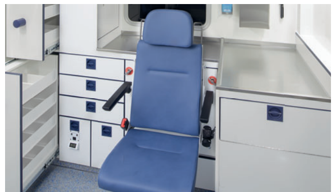
Durchdacht installierte Fächer und Schubladen sowie der geteilte Apothekerauszugschrank ermöglichen eine übersichtliche Aufbewahrung und bieten maximalen Stauraum.
