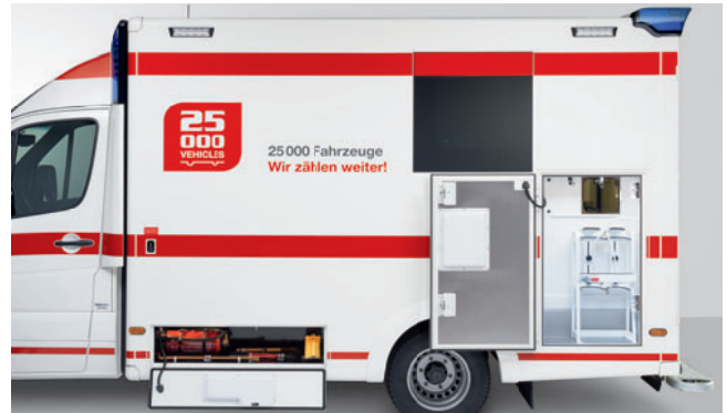
Platzsparend und sicher: Sauerstoffversorgung im Außenstaufach, das Bergwerkzeug im Unterflurfach.
