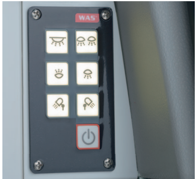
Die effiziente LED-Beleuchtung ist zusätzlich über ein Panel am Heckschrank steuerbar.
