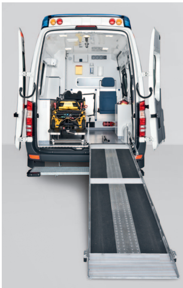
Die Beladerampe aus Aluminium ermöglicht ein komfortables und sicheres Einschleusen des Tragestuhls.
